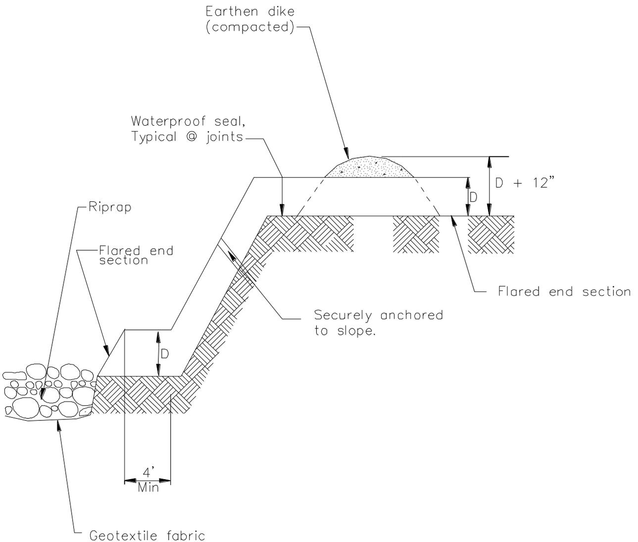
TYPICAL SLOPE DRAIN
